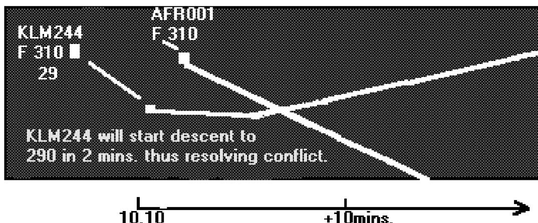
Fig.vi. The resolution manoeuvre.
